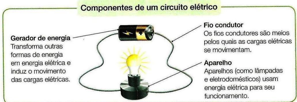
Componentes básicos de um circuito elétrico.
